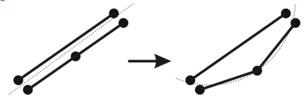
Una delle due linee sovrapposte (es. due confini comunali) ha un vertice in più. Proiettando i vertici in un altro sistema il vertice centrale si allontana dall'altro bordo: i confini non sono più coincidenti.
