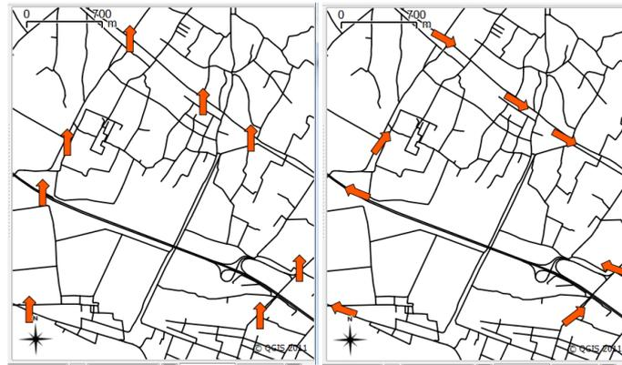
Figura 6.14: A sinistra i simboli stradali senza allinamento, a destra con allinamento automatico con la strada più vicina.
