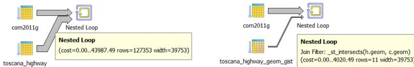
Figura 6.7: Clip, indici e efficienza. A sinistra il piano di esecuzione della query 6.13 senza indici spaziali, a sinistra con indice spaziale: il costo temporale è ridotto ad un decimo.
