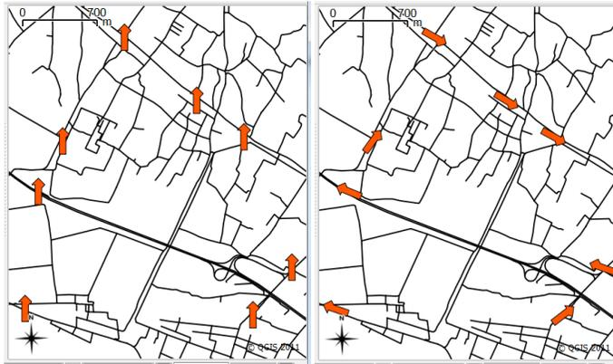
Figura 6.14: A sinistra i simboli stradali senza allineamento, a destra con allineamento automatico con la strada più vicina.
